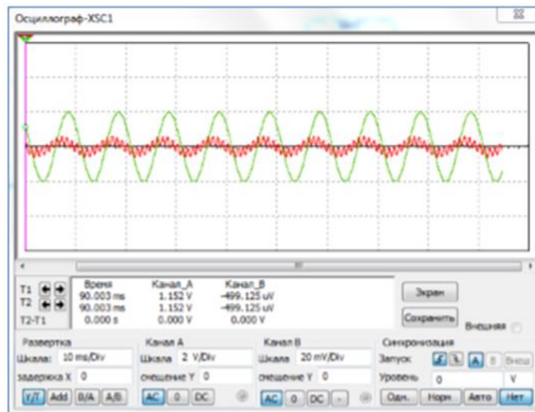
3.8 сурет – Жалпы режим кедергілеріне ұшыраған кезде құрылғыны модельдеу нәтижелері
